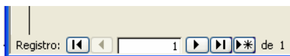
Figura 2.b: Controles de registro -o primeiro botão (⏪) volta ao primeiro registro, o segundo (⏩), volta um registro. A janela (1) mostra o número registro atual. O terceiro botão (▶) avança um
